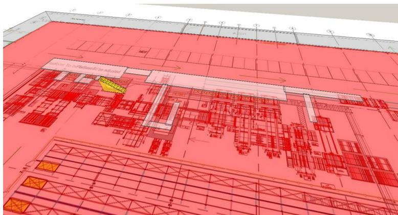
Рисунок 2. Расположение эвакуационного выхода с технологической площадки на уровень первого этажа 0.000 м
