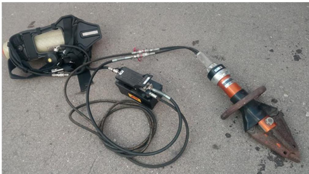
Рисунок 7. Гидравлический инструмент с пневмогидравлическим насосом
