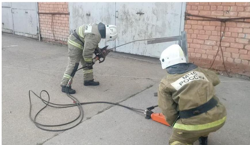
Рисунок 4. Процесс перекусывания арматуры
