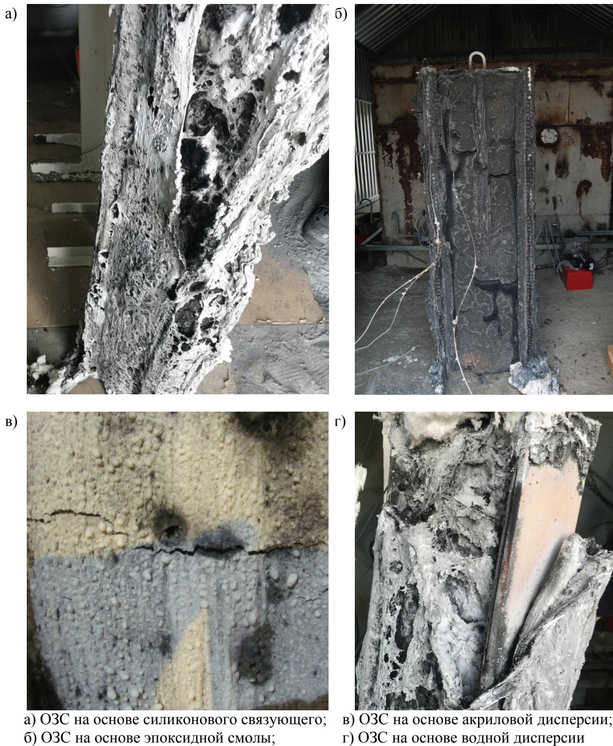
Рисунок 5. Внешний вид ОЗС интумесцентного типа после огневых испытаний в условиях углеводородного температурного режима
