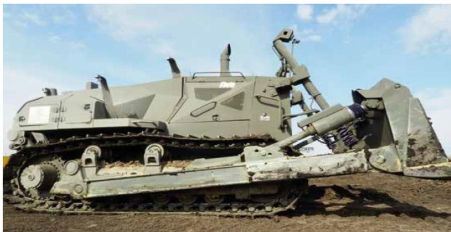
Рис. 1. Дистанционно управляемый бульдозер D-12
