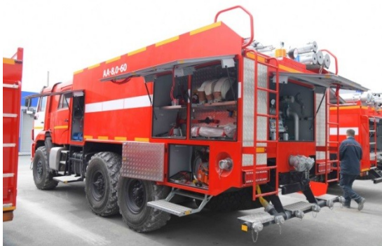
Рис.3. Аэродромный пожарный автомобиль АА-8,0/(30-60) (43118)
