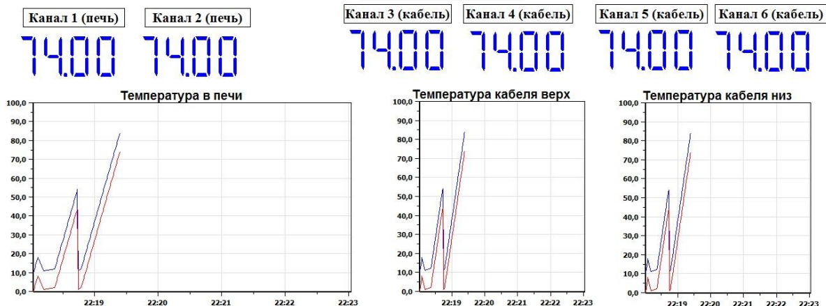
Рис. 3. Монитор реального времени SCADA-системы SimpLight FREE 32 отображающий числовые значения и графики изменения температур после обработки данных с термопар
