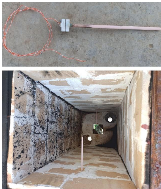
Рис. 4. Общий вид термопары ТПП (тип S) и их размещение в испытательной установке
