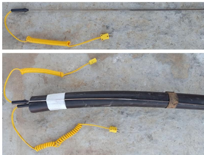
Рис. 1. Общий вид термопары ТХА (тип К) и их размещение на кабельном изделии
