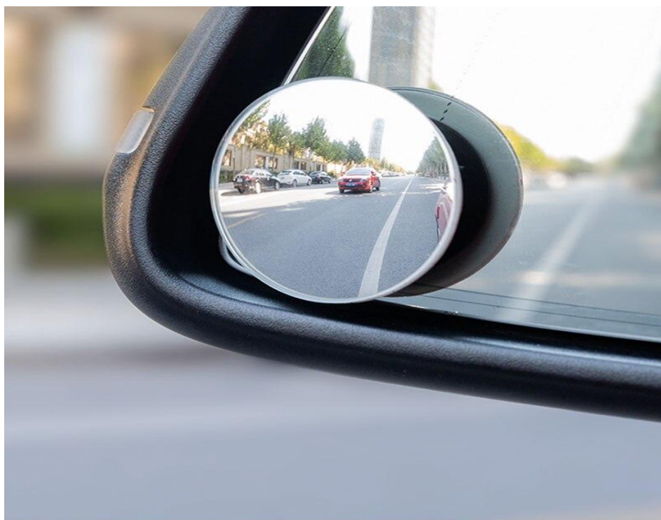
Рис. 1. Вариант использования сферического зеркала для улучшения обзора
