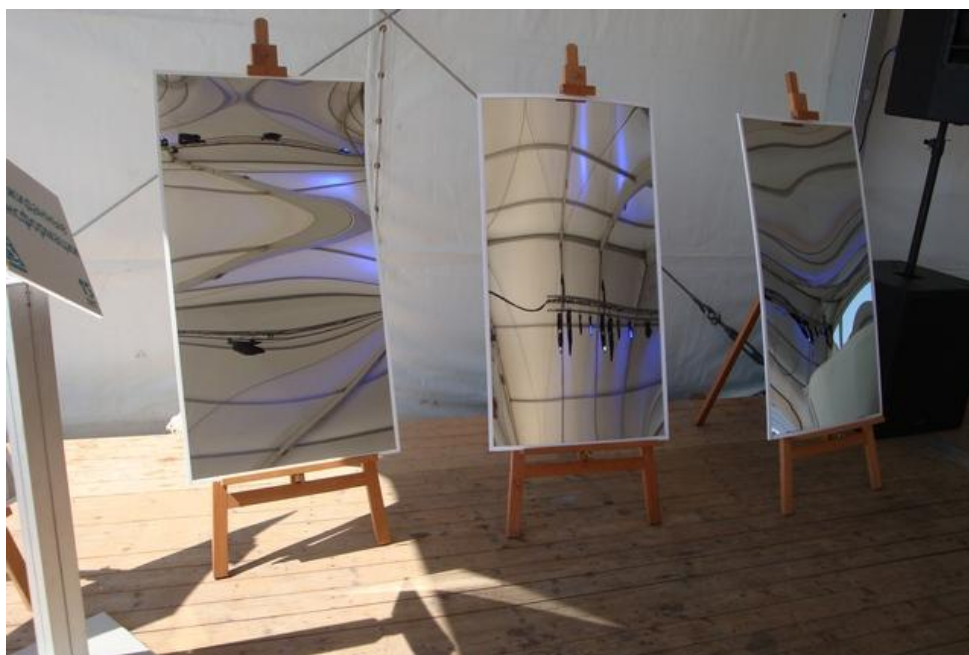
Рис. 3. Деформация изображений в кривых зеркалах
